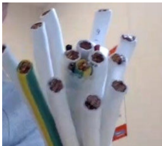
Figur 6 – Eksempel på kabel med fire parallelle ledere per fase og fire pilotledere
