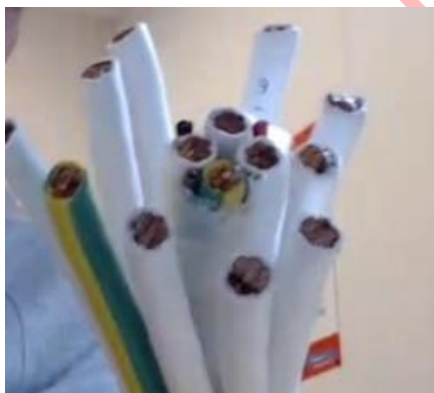
416 Figur 6 – Eksempel på kabel med fire parallelle ledere per fase og fire pilotledere
