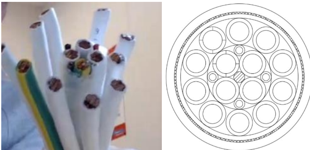
Figur B.1 – Bilde og snitt av SEI 4 x 3x16mm 2 + 2 x 16mm 2 + 4 x 2,5mm 2
