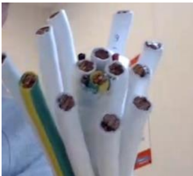
Figur 6 – Eks på kabel med fire parallelle ledere per fase og fire pilotledere
