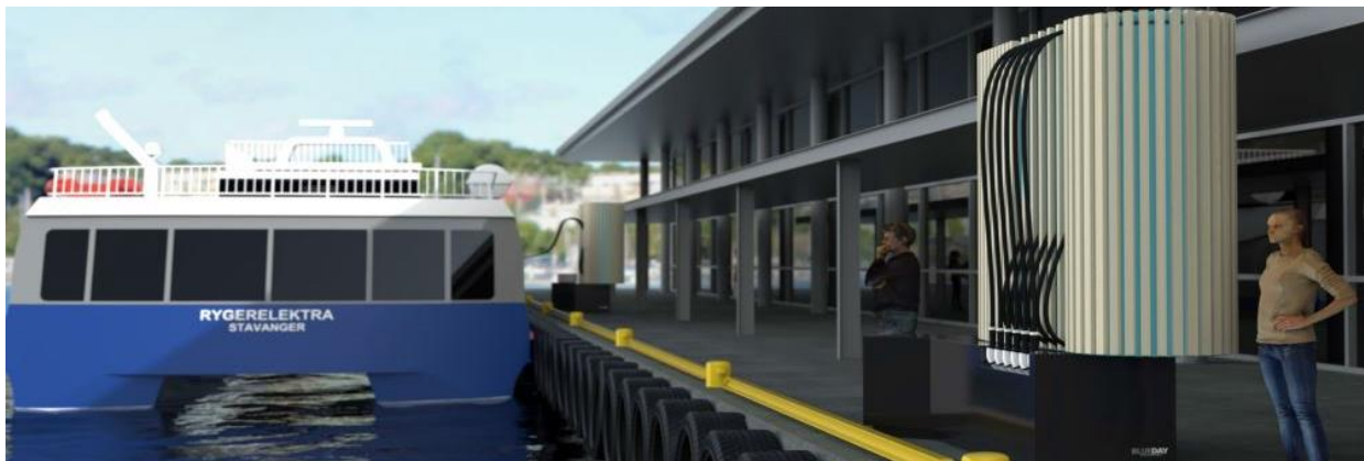
Figur C.2 viser et manuelt håndterbart system basert på flere parallelle CCS2 tilkoblinger.
