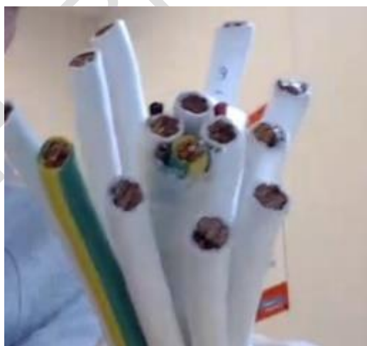
Figur B.1 – Bilde og snitt av SEI 4 x 3x16mm 2 + 2 x 16mm 2 + 4 x 2,5mm 2
