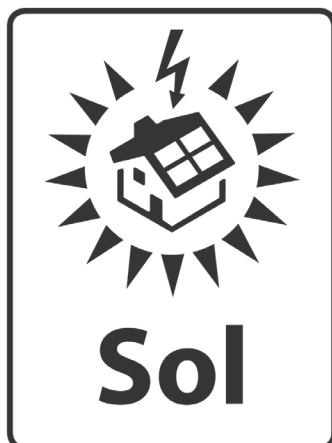
Figur 712A - Eksempel på merking av at en bygning har en solcelleinstallasjon
