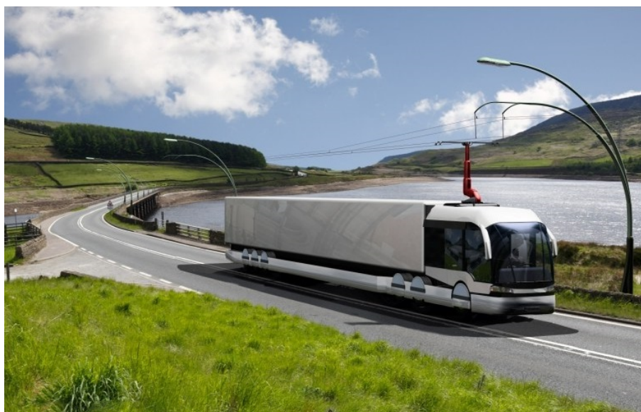
Figur 3.9: Svenska Elvägar har arbeidet med elektriske veier siden 2008, og planlegger en litt mer elegant løsning med kjøreledning i framtiden. Illustrasjon: Elvag.se
